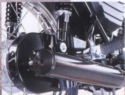
gekapselte Kette, 3fach verstellbare Federbeine
